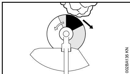
**Povećana opasnost od povratnog udarca** postoji kada alat u **crnoj oblasti** nađe na prepreku.
