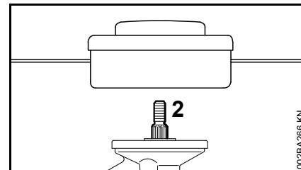
Moguća je ugradnja samo onih glava za košenje, koje se direktno mogu pričvrstiti na vratilo (2).
