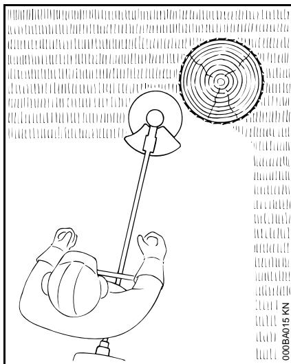
Za meki "rez" – za precizno rezanje i kod neravnih ivica oko drveća, stubova ograda itd. – za manja oštećenja kore drveća.
