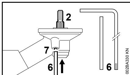
Kod montaže i demontaže reznih alata, neophodno je blokirati vratilo (2) utičnom iglu (6) ili ugaonim odvijačem (6). Delovi se nalaze u obimu isporuke, a dostupni su i kao poseban pribor.
